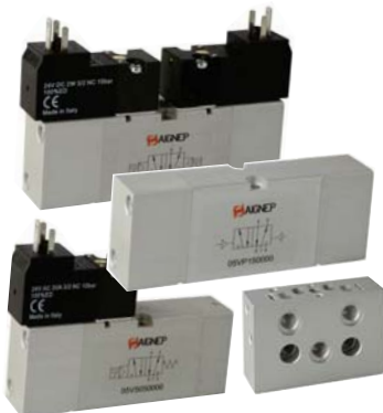
Elektro- i pneumatski ventili 18 mm serije 05VS, po VDMA standardu 5/2 i 5/3, kapaciteta 550 Nlit/min, za montažu na modularnu bazu.
