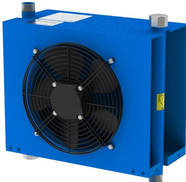
*In questa serie di refrigeratori finali, la batteria alettata generosamente dimensionata ed i potenti ventilatori elettrici permettono di abbattere la temperatura dell'aria compressa da 120°C fino ad una temperatura di uscita superiore a quella ambiente di soli 3°C.*
